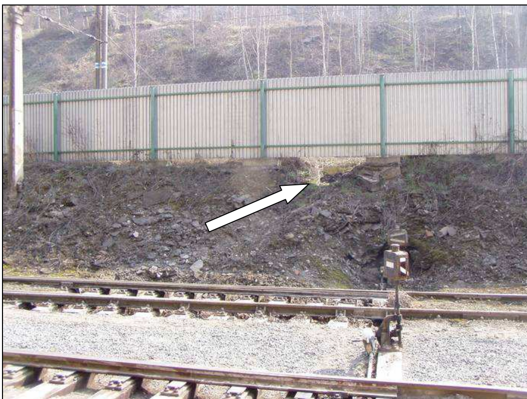
Obr. č. 22 - KS12 pro ověření existence opěrné zdi v km 40,780 - pohled na prostor kopané sondy za výhybkou vlečky v cementárně. Poloha sondy viz šipka.
